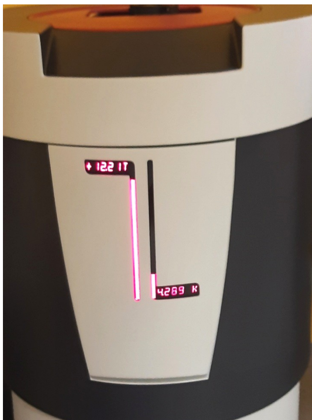
Вид на переднюю панель модуля криостата системы PPMS® DynaCool с включенными индикаторами напряженности магнитного поля (слева) и температуры (справа) в зоне образца
